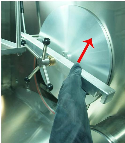
(1) 逆时针旋转手柄，图（11-5）；      (2) 向箭头方向抬起方钢，图（11-6）
