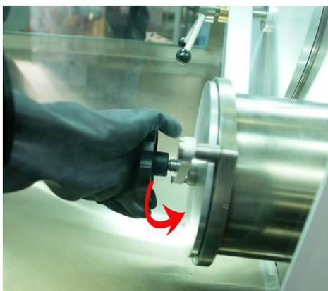
图（11-11）逆时针旋转手柄，打开小仓门，；
