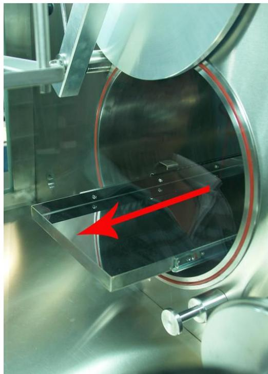
(3) 用手向箭头方向抬起方钢，图（11-7）      (4) 拉出托盘，图（11-8）
